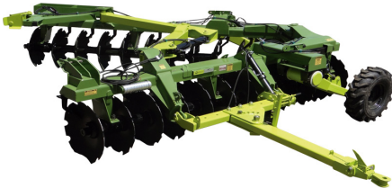
Rastra Super Pesada con Abertura Mecánica o Hidráulica Especial
