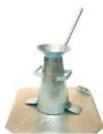
Slump Test para concreto
